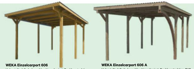
Holzart: Nadelholz, kesseldruckimprägniert, Dachkonstruktion: PVC-KST-Flachdach mit Wellenprofil, mit 1,2 mm starken Dachplatten, Pfostenstärke: 90 mm, Durchfahrtshöhe: 235 cm, Sockelmaße (BxT):
